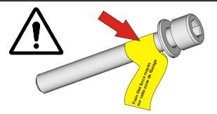
**4** - Sur la vis fournie dans le kit, enduire les filetages de frein filet force "moyen" sur la zone définie par le ruban adhésif.
