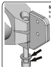
**5** - Déposer une fine couche de graisse sur les portées de vis et de rondelle suivant les flèches.
