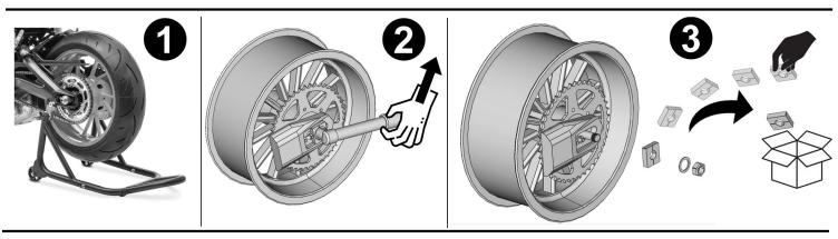
Si necessaire, inverser le sens d'insertion de l'axe de roue / If necessary, reverse the wheel axle direction
