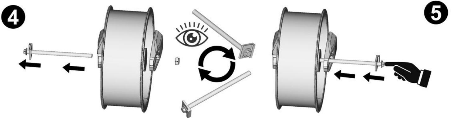
Inverser le sens d'insertion de l'axe de roue / Reverse the wheel axle direction
